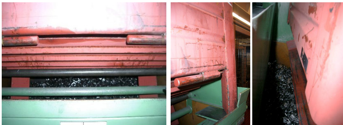
Aufsetzen des Klappbodenbehälters mit einem Gabelstapler zur Entleerung
